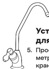
5. Просверлите отверстие диаметром 12 мм в выбранном для крана чистой воды месте раковины или столешницы.
